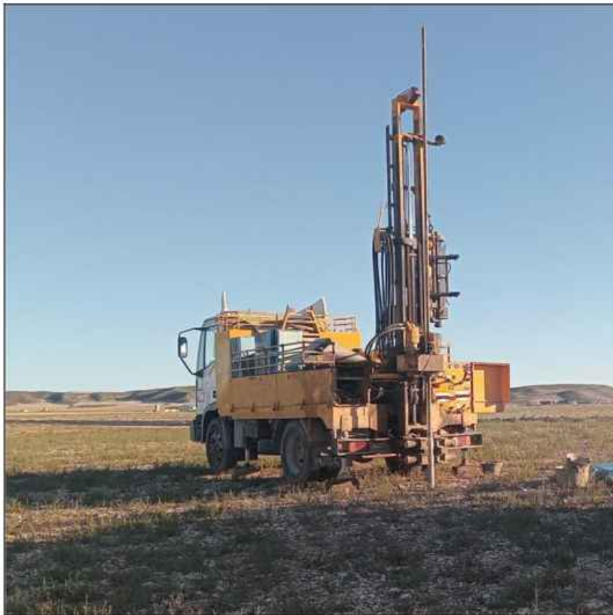
Figura 10. Equipo de perforación durante los trabajos de campo.
